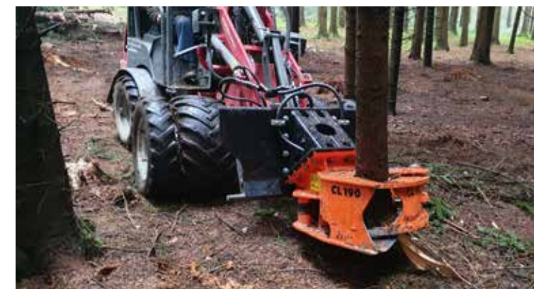
Woodcracker® CL schneidet weiches Holz bis zu 40cm.
