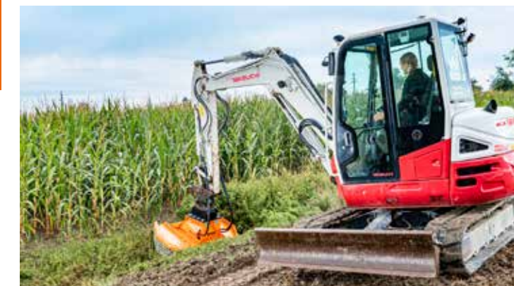
Der Mulcher bei der Böschungspflege.
