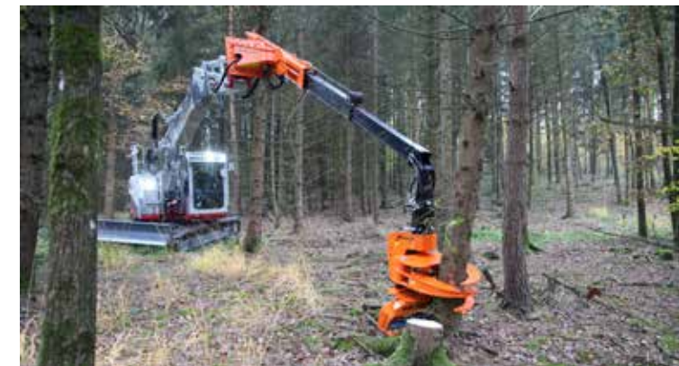
Reichweitenerhöhung bis zu 6,35m.
