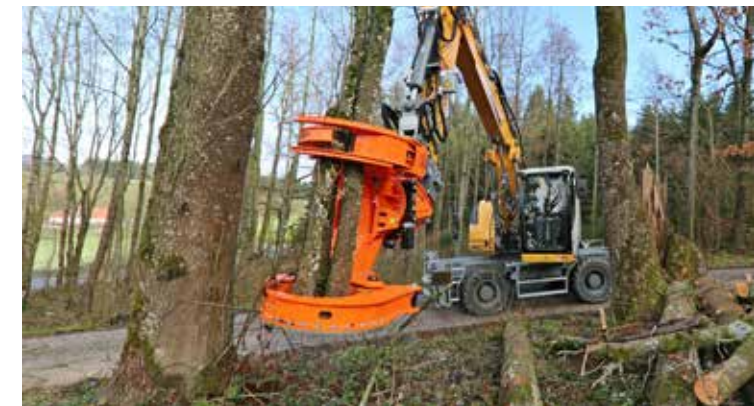
Woodcracker® C bei der Verkehrssicherung.
