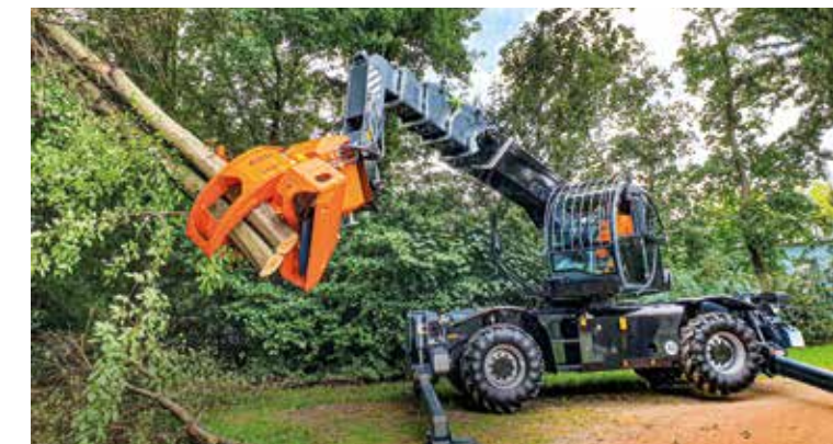
Automatische Kettenspannung, endlos drehbar.
