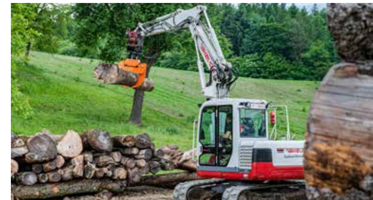
Starrer oder kardanischer Anbau möglich.
