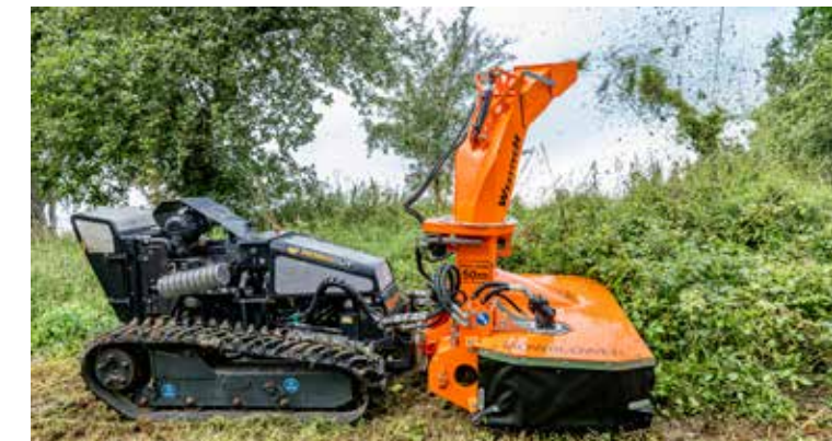
Der Mowblower® kann an ferngesteuerte Geräteträger angebaut werden.
