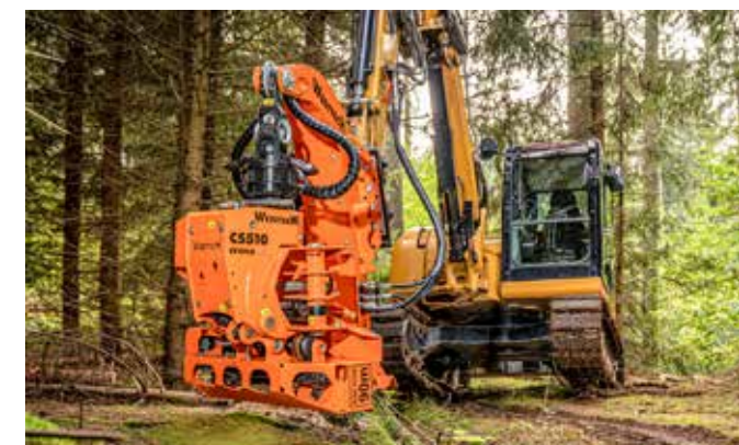
Der Schreitfuß ermöglicht dem Bagger sich fortzubewegen, wenn kardanische Geräte angebaut sind.
