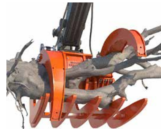
individuelle Anpassung der Greiffinger an das Erntegut
