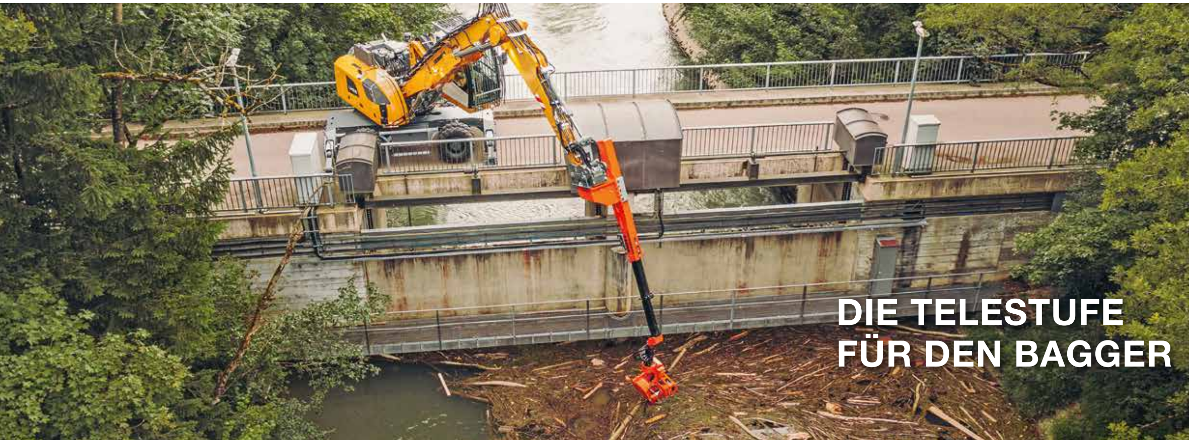
Reichweitenerhöhung bis zu 6,35m.
