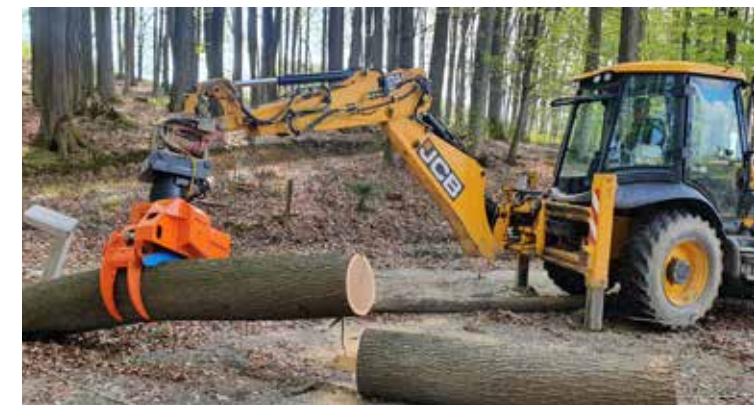
Robuster und verschleißbarer Holzgreifer, inkl. Säge.
