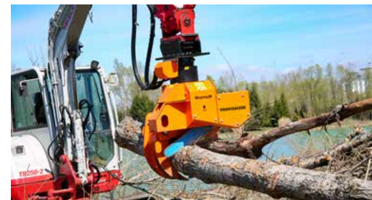
Kann am Kran, Rückewagen oder Bagger angebaut werden.
