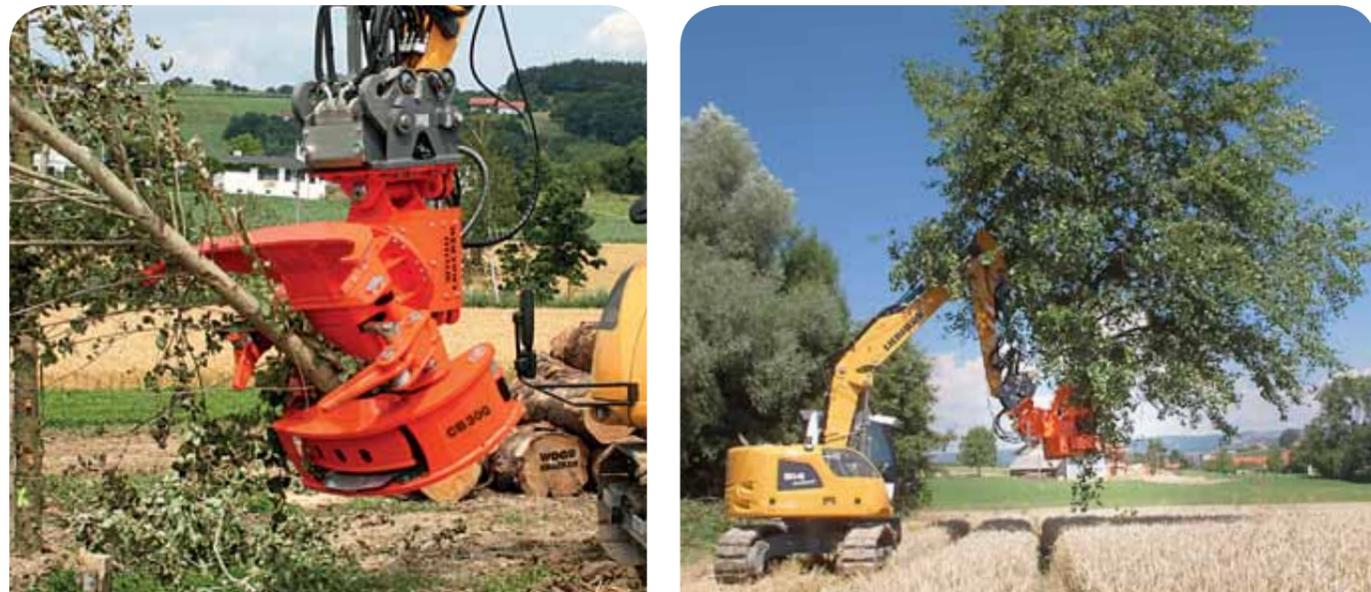
Die agilen Erntemaschinen Woodcracker® CB 230 und CB 300 wurden speziell für die rasche Ernte von kleineren Bäumen und Sträuchern bis zu 35 cm Durchmesser entwickelt. Die innovative Abladeautomatik und die automatisierten Bedienungsvorgänge ermöglichen eine schnelle Ernte.
