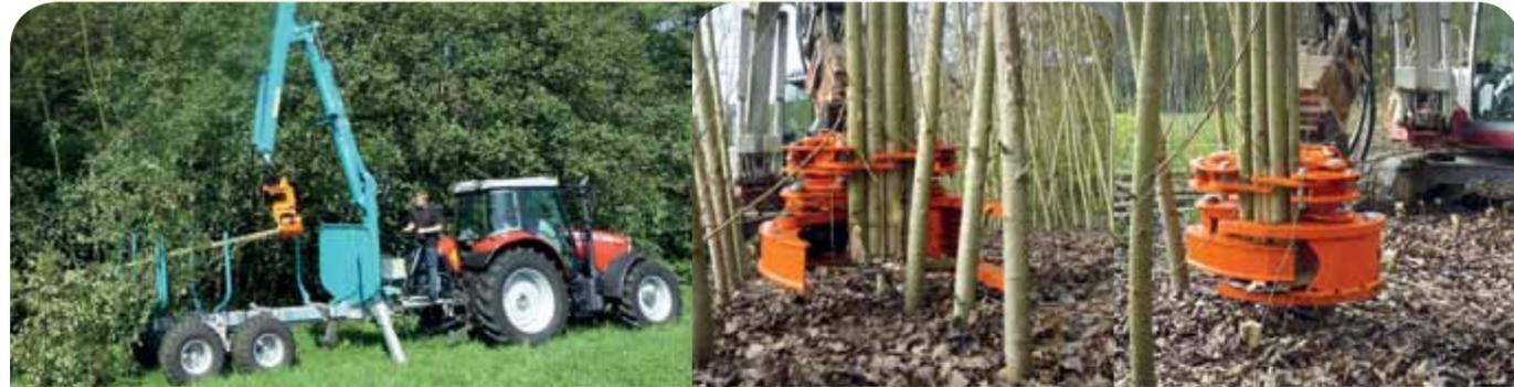
Der Energieholzernter Woodcracker® CB 150 wurde speziell für die problemlose Ernte von schwachem Holz bis zu 25 cm Durchmesser entwickelt. Das Haupteinsatzgebiet liegt in der Ernte von Energieholz und Kurzumtriebsplantagen.
