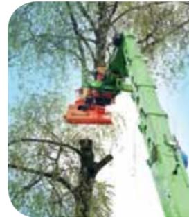
Woodcracker CS 580 smart ist dank leichtem Eigengewicht für den Anbau an Roto-Teleskader oder Bagger bestens geeignet. Spezialbaumabtragungen z.B. entlang von Gärten oder im städtischen Bereich lassen sich problemlos durchführen.
