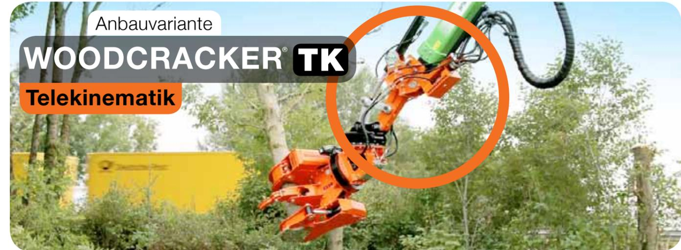
Anbauvariante Woodcracker® TK: Der Verbindungslink. Herstellerunabhängig anbaubar.
