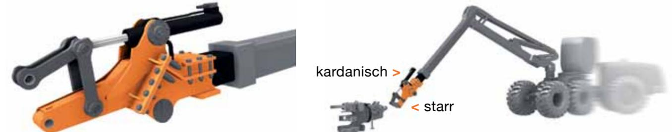
Flexibel und schnell arbeiten > Der Verbindungslink kombiniert kardanischen und starren Anbau.
