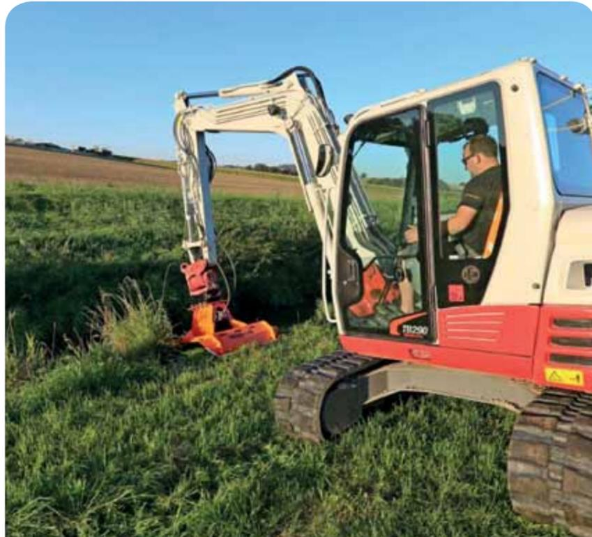
hier: **MULCHER** Anbau an gängige Bagger von 7 bis 14 Tonnen.
