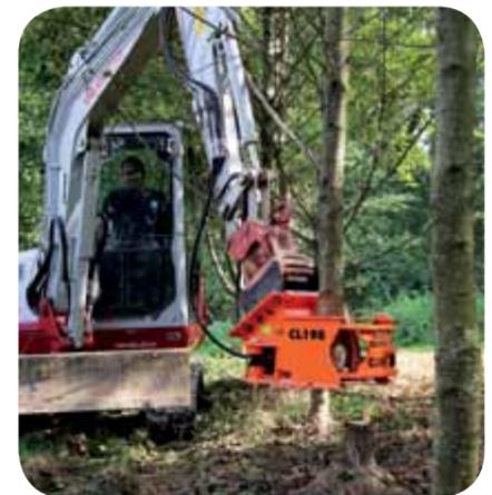
Der Schneidkopf Woodcracker® CL 190 wurde speziell für die einfache Ernte von schwachem Holz bis zu 25 cm Durchmesser entwickelt.
