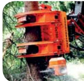
Die starre Anbauweise des Woodcracker CS auf dem Bagger ermöglicht die stehende Entnahme von Teilstücken des Baumes aus seiner Umgebung. Dadurch werden umliegende Bäume oder Gebäude nicht beschädigt – ideal für Sicherheitsfällungen.
